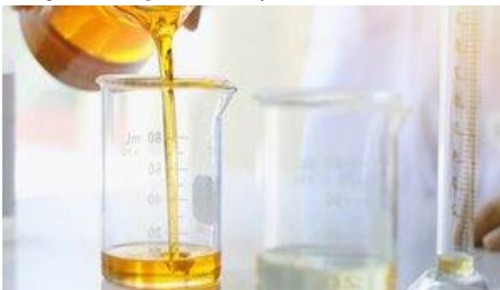
2. Memasukkan *sample* oli yang akan diuji ke dalam pipa viskometer bath kohler.
